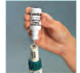
PH110 incluye electrodo pH recargable, de superficie plana
