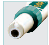
PH100 incluye electrodo pH de superficie plana
