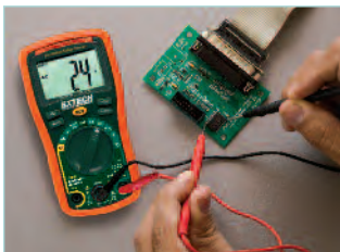
Autorrango — Selecciona automáticamente el mejor rango de medición para lecturas precisas.
